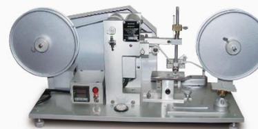
R. C. A纸带耐磨试验机
