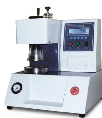
全自动破裂强度试验机
