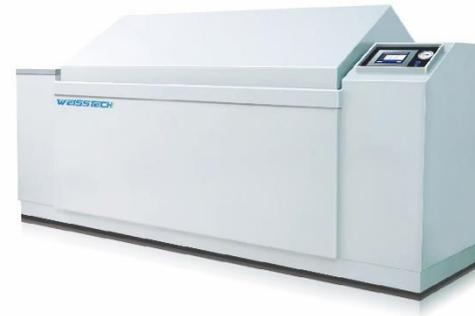
复合式盐雾试验箱是加速腐蚀试验中最接近实际的状况，以自然环境中较常见之状况加以模拟，以数倍于自然环境之严苛条件加以组合测试，如盐雾、干燥、湿润、常温静置、低温等环境加以组合，可任意顺序或单独进行测试。主要测试品乃针对在激烈环境变化下使用的产品，如汽车零配件、航空器材、摄影器材、建筑材料、电镀涂膜涂料及电子电机系统等金属电化学腐蚀抗抵性皆适用。
